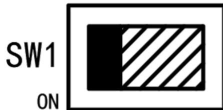
下图中开关状态为冷端（参考端）温度测量功能不工作状态，此时温度传感器不输出工作，TB-68CJ 可作为基础的 68pin 屏蔽接线盒使用（仅导线连接）。
